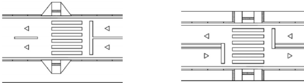
FIGURA 4: FAIXA DE PEDESTRES COM GUIA REBAIXADA NO MEIO DE QUADRA COM CANTEIRO CENTRAL.
